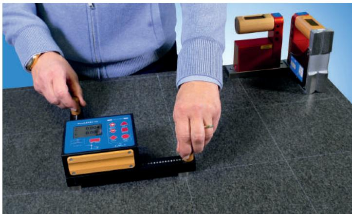
Программное обеспечение wylerSPEC позволяет использовать возможности уровня BlueLEVEL-2D полностью: Измерение, обработка и отображение значений по осям X и Y одновременно.
