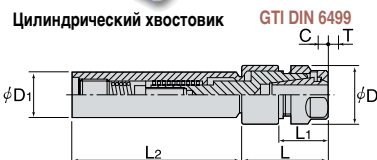
Цилиндрический хвостовик GTI DIN 6499
