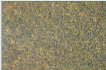
Мелкозернистый сплав (2000 x)
