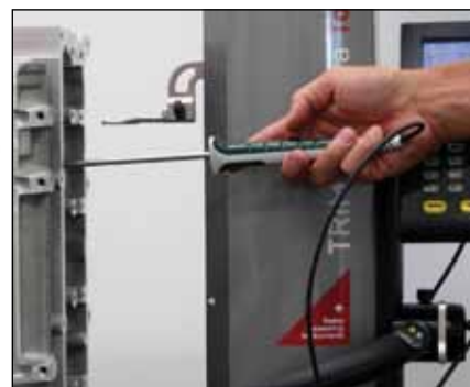
Измерение с использованием системы температурной компенсации и доп. щупа.
