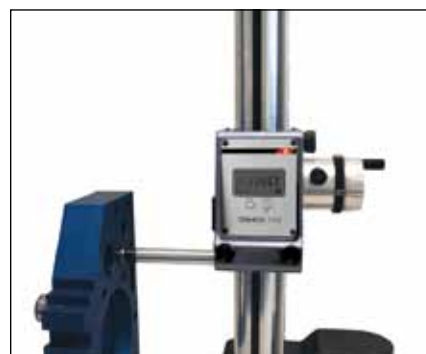
Измерение межцентрового расстояния
