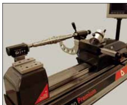
HPA: Измерение параметров цилиндрических деталей (TA-MS-303)
