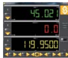
Отображение результатов измерения с нескольких инструментов с цветной индикацией допусков
