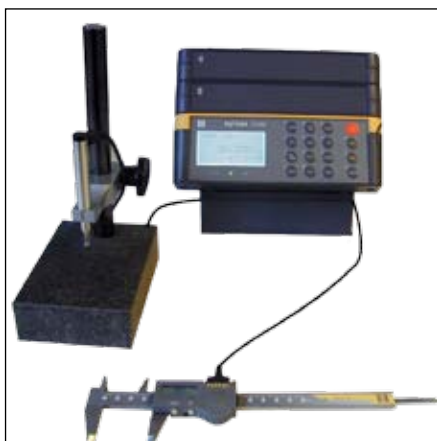
Одновременное подключение щупа и измерительного инструмента
