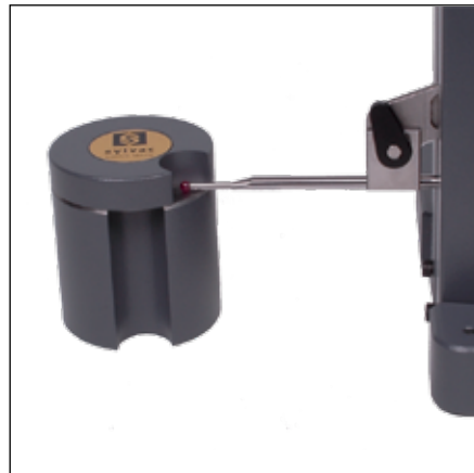
Калибровка шарика измерительной вставки
