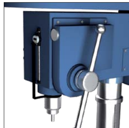
Модернизация сверлильного станка с измерительной осью Z
