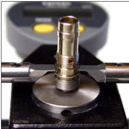
Столик с настраиваемой по высоте поверхностью. Доступны различные размеры
