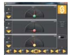
Отображение результатов измерения с нескольких инструментов в аналоговом режиме
